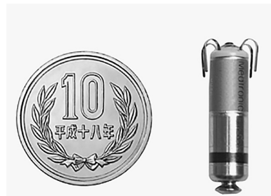
図4 リードレスペースメーカーの大きさ (日本メドトロニック社より提供)
