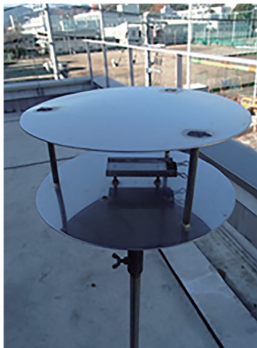
【図4】ダーラム式花粉捕集機器
